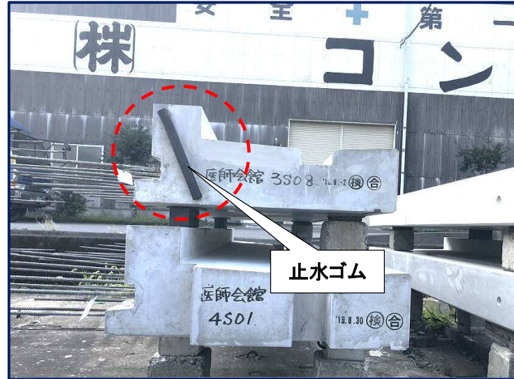
【 工場PC板 保管状況 】
