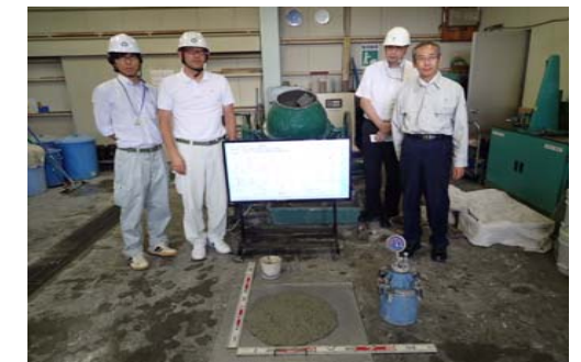
水中不分離性コンクリート試験練
