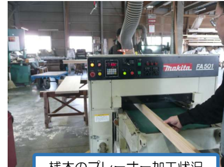
桧木のプレーナー加工状況
