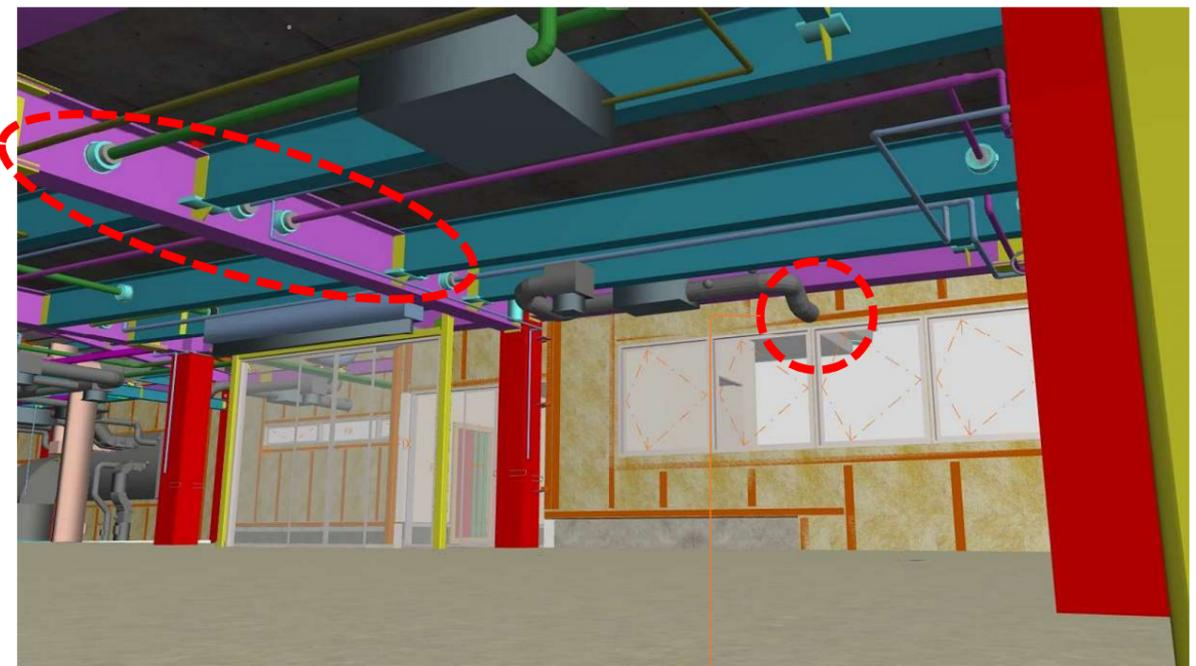
サッシ開口と設備ダクトの干渉状況確認
