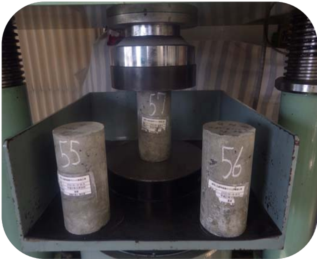
自作のテストビラパルによる 供試体の信用性の向上
