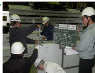
プール工場検査にて寸法、溶接性能確認
