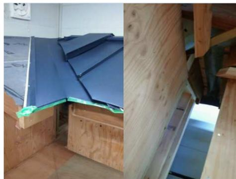
模型にはキャスターを付け、地震の様に揺らしてみました。板金の笠木及び谷樋はなんとか動きに追従できるようです。普段、絶対雨漏りしない事、地震時、建物の動きのズレに対して、破断することなく、最低限度の雨仕舞を確保できると思います。
